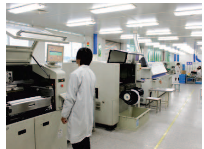
Линия для автоматизированного монтажа печатных плат
